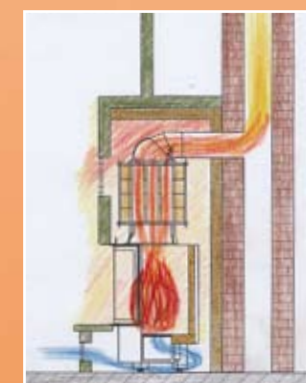
Schmid-Feuerungstechnik als Kaminanlage mit schwerem Aufsatzpeicher.
