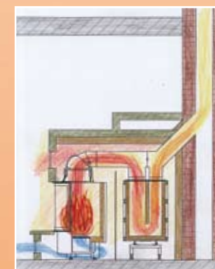
Schmid-Feuerungstechnik als Kaminanlage mit Nachheizregister.
