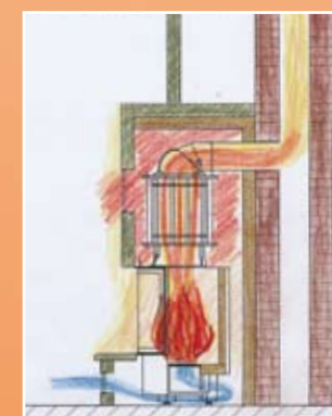
Schmid-Feuerungstechnik als Kaminanlage mit leichtem Aufsatzpeicher.
