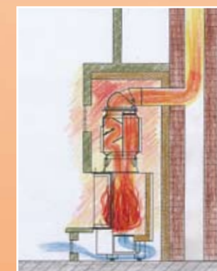
Schmid-Feuerungstechnik als Kaminanlage mit Wamluft-Aufsatzregister.
