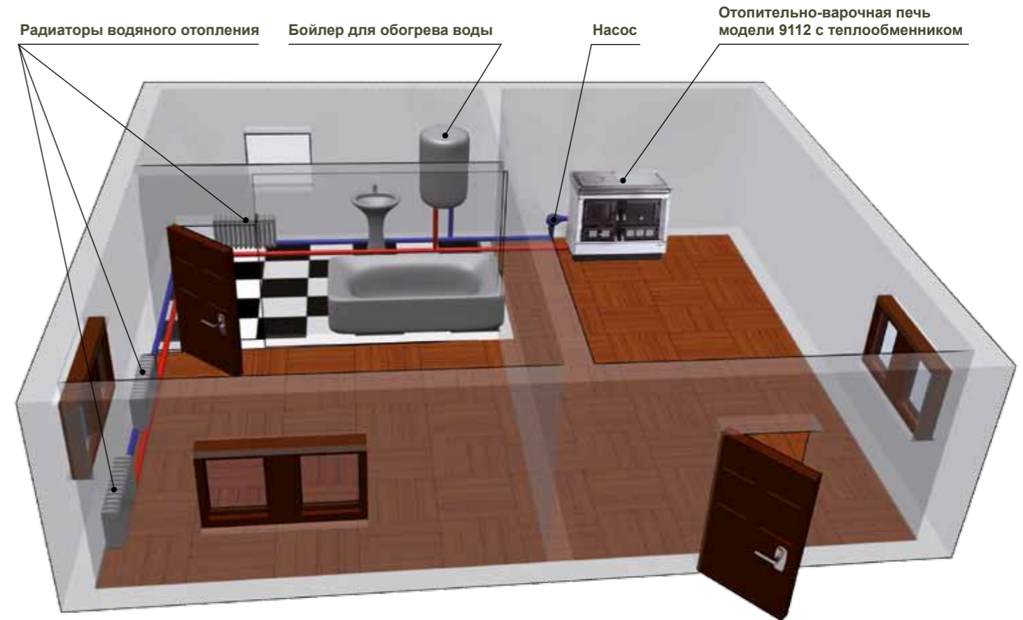
Отопительно-варочная печь с духовкой и теплообменником. Предназначена для отопления, приготовления и подогрева пищи, и подсоединения к системе центрального отопления
